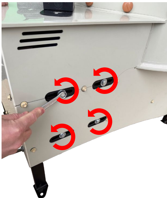
А) Рис.8 Ослабьте 4 болта крепления мотора (против часовой стрелки)
