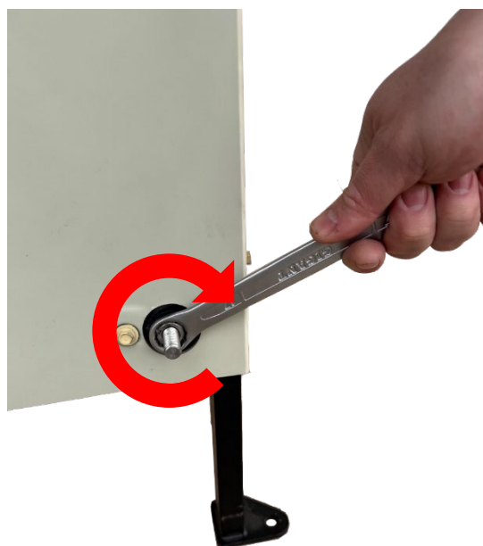
Б) Рис.9 Подтяните гайку на натяжном винте (по часовой стрелке), произойдет натяжка ремня
