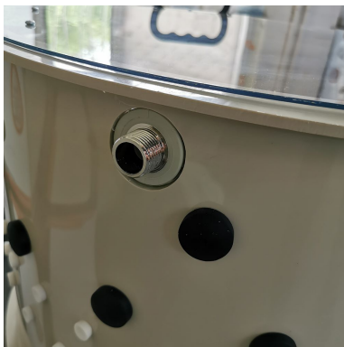
Рис. 3 – место подключения водопровода к системе орошения Plucker 500U
